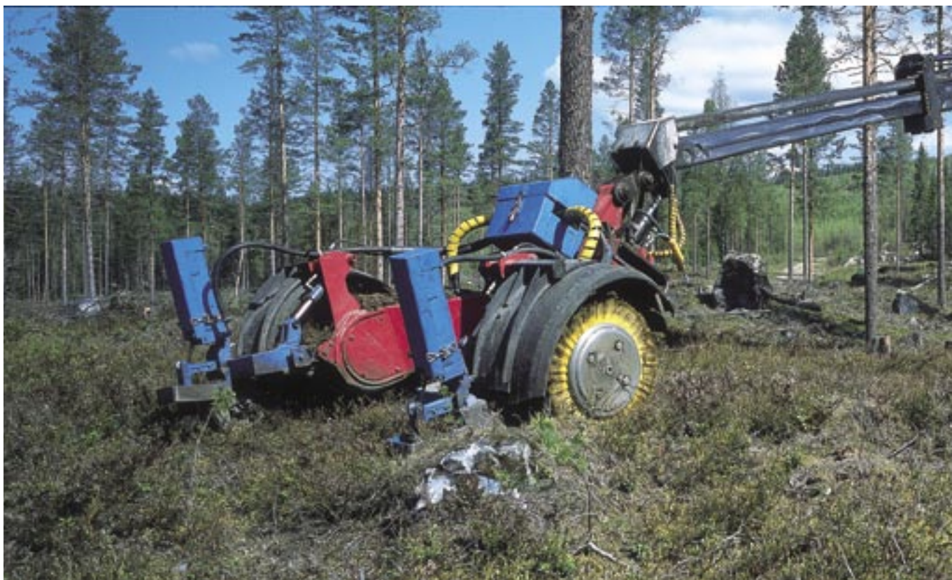
Bilden ovan: Mekaniserad markberedning och sådd med Humax 24. Ett exempel på framgångsrik utveckling av skogssådd. Foto: Holmen Skog.
