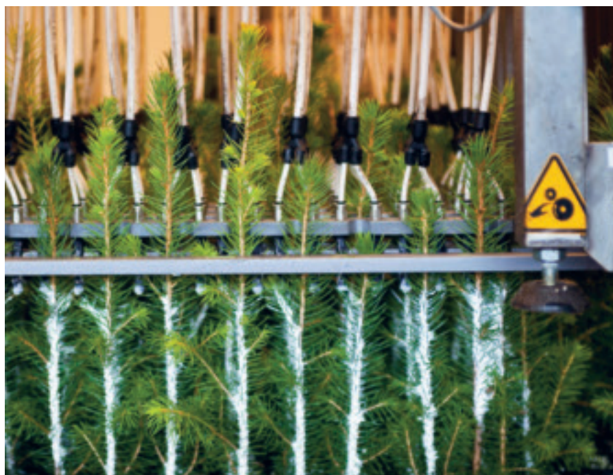
Ett vattenbaserat lim läggs på plantan innan den går vidare till sandningsstationen. Foto: Per Wichmann
