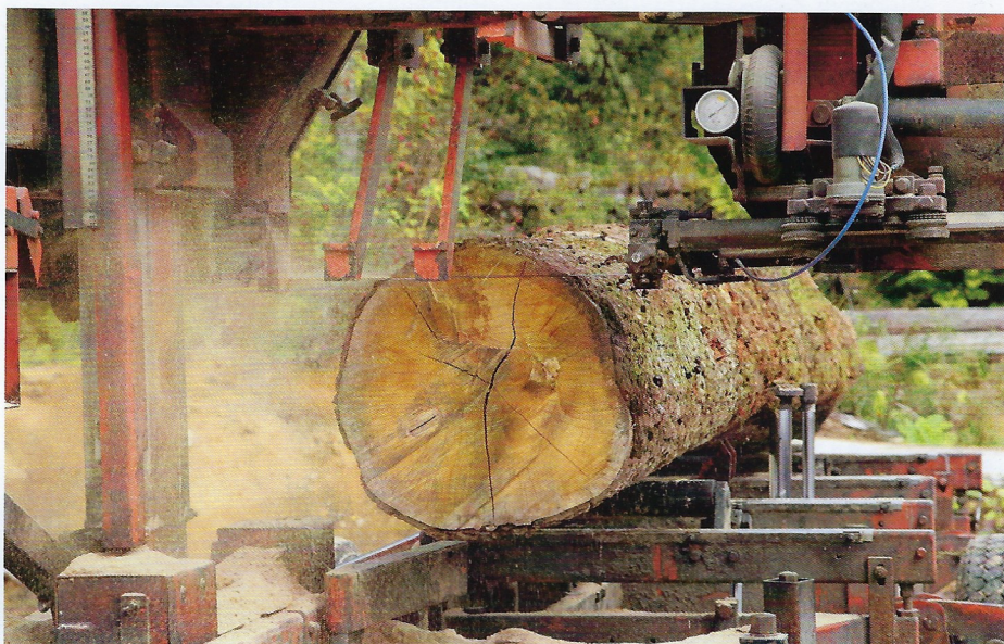
Många småsågar ser till att förädla ekvirket. Här är det Ängavången i Bosarp som gör golvvirke av stockarna. Foto Mats Hannerz.
